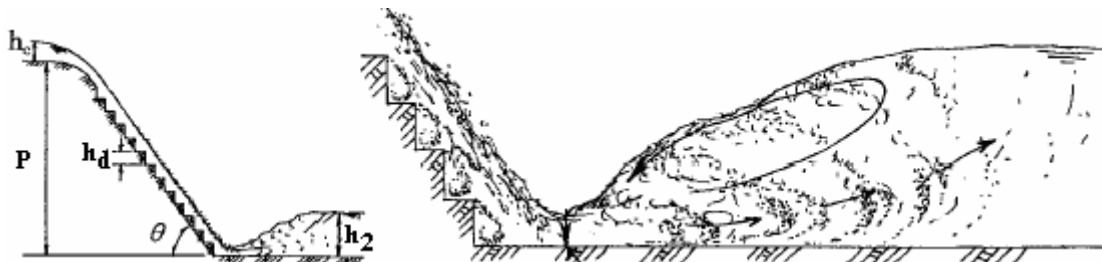
Figura 8 – Definição esquemática de um descarregador em degraus (Boes, 2000).
